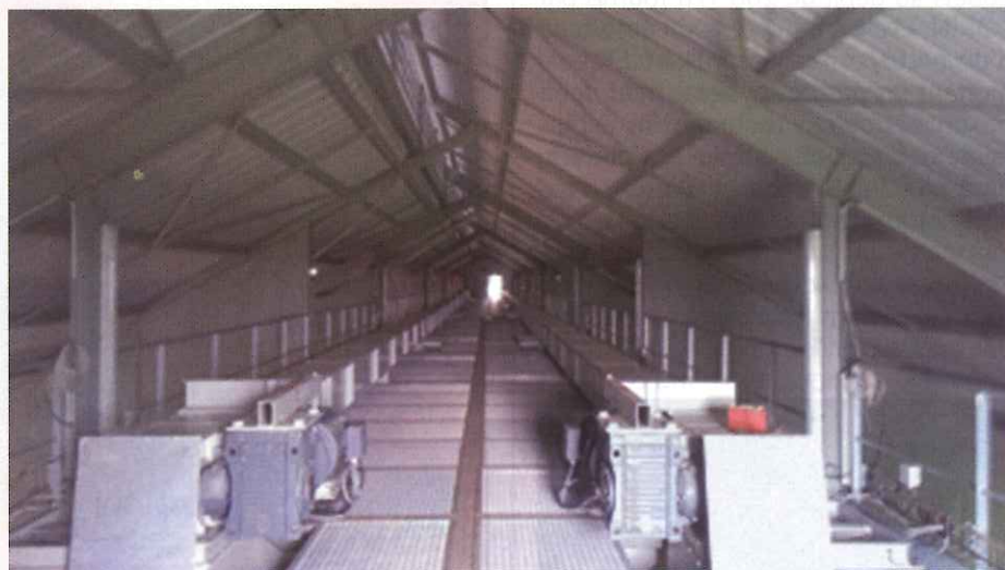
► Les dix cellules de stockage en deux rangées de cinq sont alimentées par deux transporteurs à chaîne LORIN / The ten storage cells in two rows of five are fed by LORIN chain conveyors (doc. GILLOUAYE).
